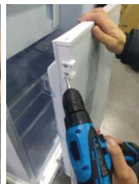
Schritt 3: Entfernen Sie die Verschlusschraube und die Schieber
