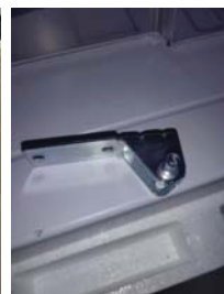
Schritt 5: Entfernen Sie das untere Scharnier
