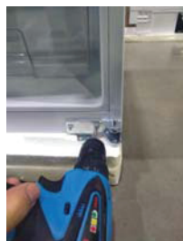
Schritt 5: Entfernen Sie das untere Scharnier
