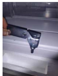
Schritt 6: Befestigen Sie die Scharnierachse auf der gegenüberliegenden Seite
