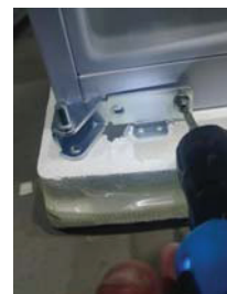
Schritt 7: Befestigen Sie das untere Scharnier auf der gegenüberliegenden Seite
