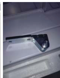
Schritt 5: Entfernen Sie das untere Scharnier
