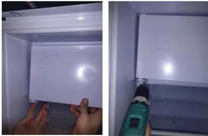
Schritt 5: Setzen Sie die Tür ein und schließen Sie sie. Befestigen Sie dann den Scharnierhalter auf der linken Seite.
