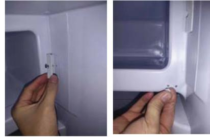
Schritt 4: Befestigen Sie den inneren Türblock und montieren Sie die Lochstopfen auf der rechten Seite.
