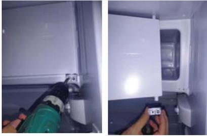
Schritt 2: Entfernen Sie die Befestigungsschrauben der Innentür und legen Sie die Innentür beiseite.
