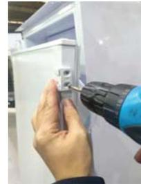
Schritt 2: Legen Sie die geschäumte Tür beiseite und entfernen Sie die Tür
