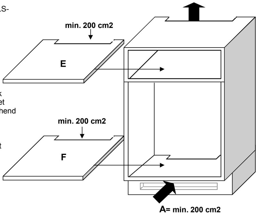
**!** Falls über dem Kühlschrank noch Schrankregale (E) angeordnet sind, müssen auch diese entsprechend ausgeschnitten werden
