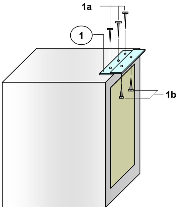
1. Den oberen Fixierbeschlag **(1)** mit 3 Schrauben **1a** oben am Gehäuse des Gerätes montieren.
